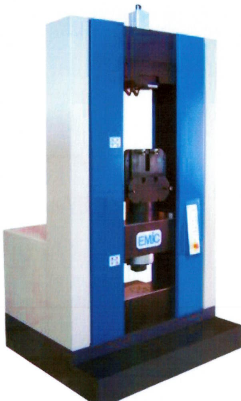
Figura 4. 11 Máquina Universal de Ensaio, eletromecânica e microprocessada EMIC modelo DL60000.
