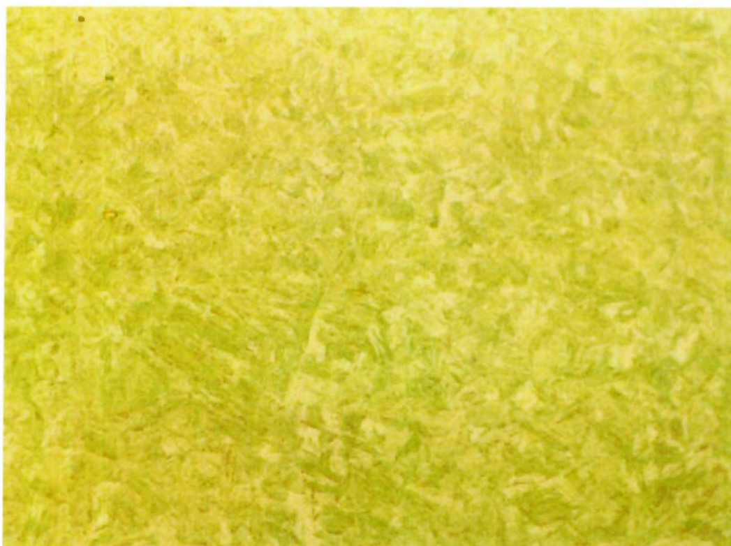
Figura 4. 5 Micro estrutura do metal de base (PHS) aumento 500x.
