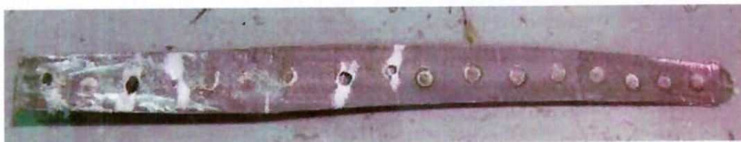
Figura 4. 6 Corpos de prova obtidos de peças veiculares já manufaturadas pelo processo "PHS"
