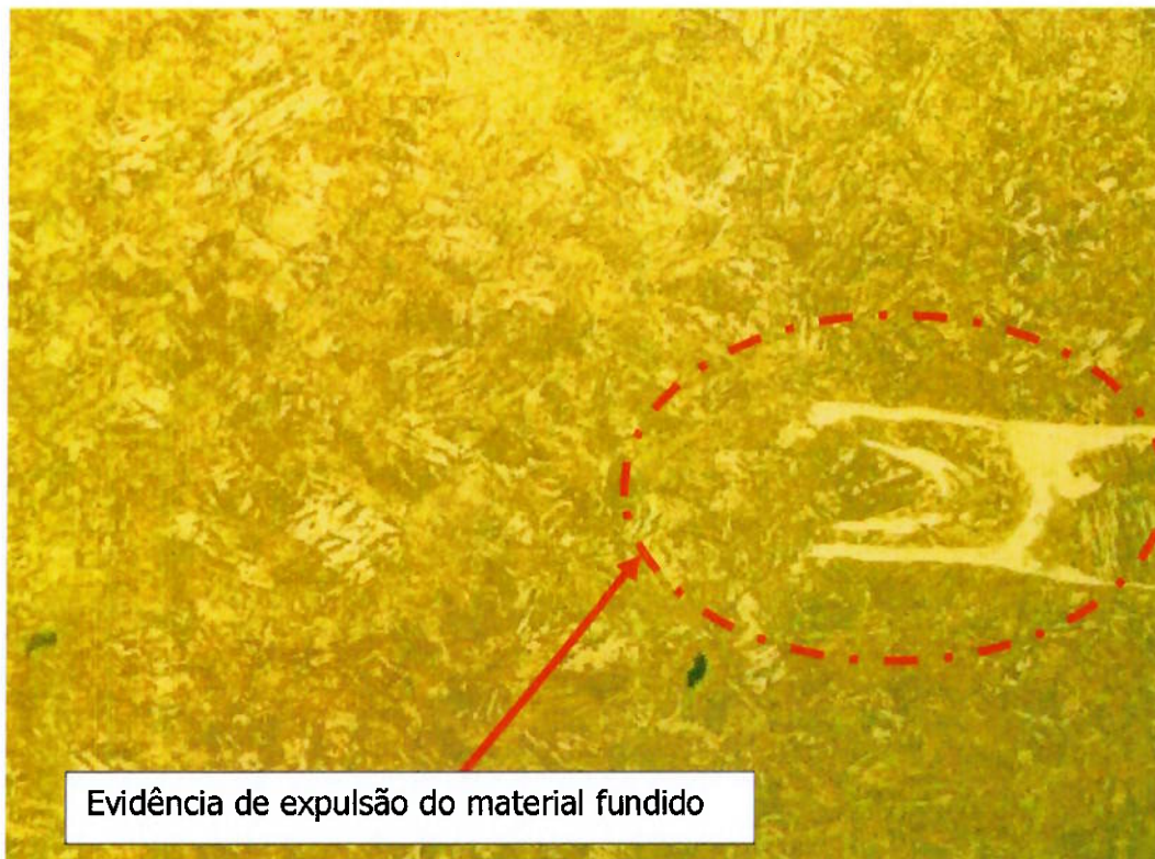
Figura 5. 17 Foto Micrográfica da região fundida da solda com aumento de 200x.
