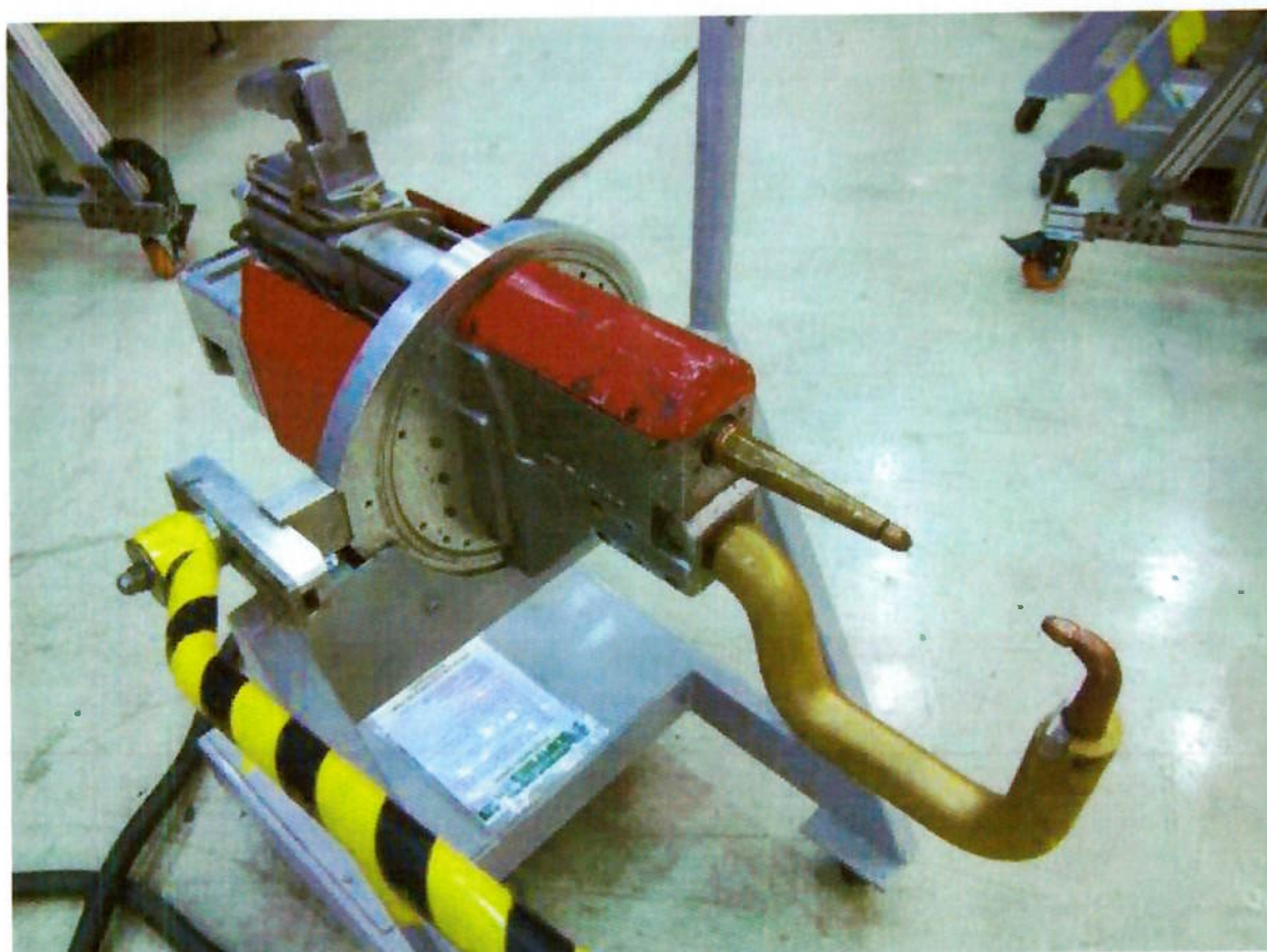
Figura 4. 1 Pinça de Soldagem Düring® MFDC tipo C
