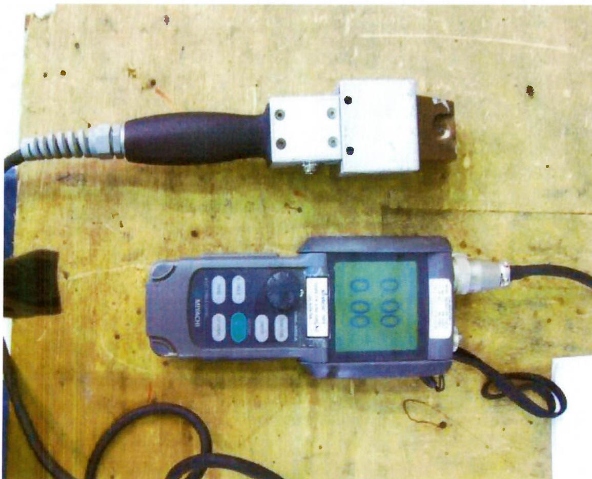
Figura 4. 10 Weld Tester MYACHI - Modelo MM-360 A (medidor de força e corrente de soldagem)
