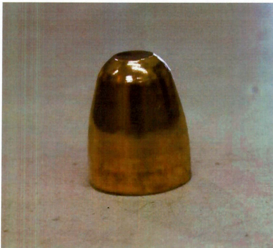
Figura 4. 2 Eletrodo utilizado no experimento. - Mat.: CuCrZr
